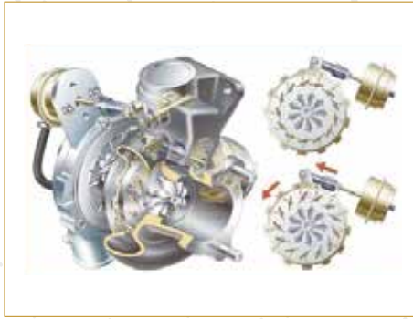
Turbo de geometría variable
