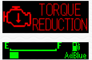
El par motor se restringe al 75% de su valor máximo.
